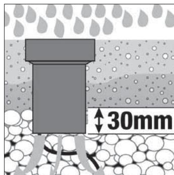
Al fine di permettere un adeguato drenaggio si consiglia di preparare un fondo di ghiaia in fase di installazione.
